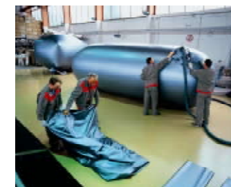
Innenhüllen bei der Dichtheitsprüfung: Alle Hüllen werden sorgfältig kontrolliert.
